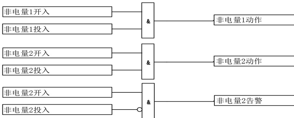
图 3-1-3 非电量保护原理框图
