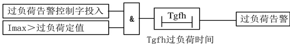
图 3-1-4 过负荷告警原理框图
