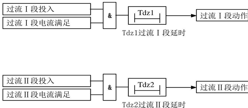
图 3-1-1 过流保护原理框图
