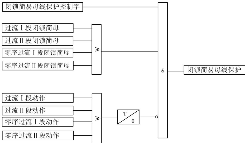
图 3-1-5 闭锁简易母线保护原理框图
