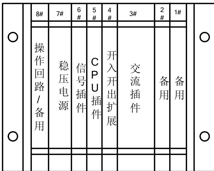
图 6-2-1 WBH-813C/H 装置背视插件布置图
