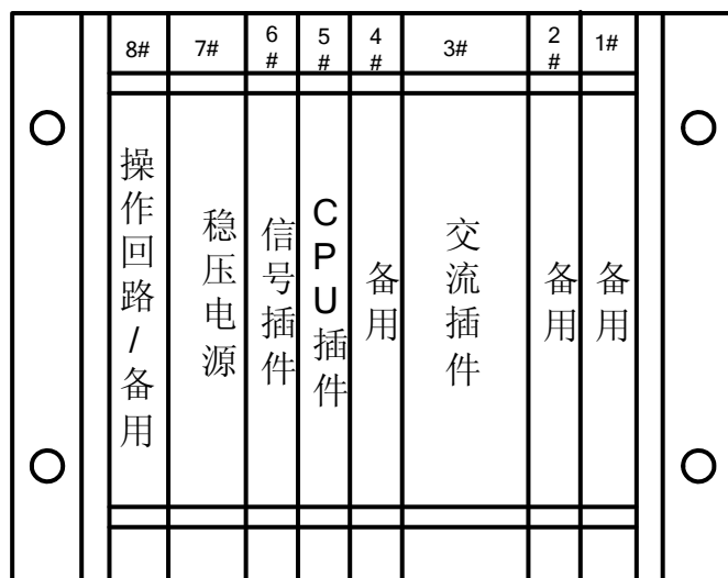
图 6-2-2 WBH-813C/M 和 WBH-813C/L 装置背视插件布置图
