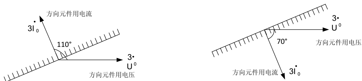
(a) 方向指向变压器时的动作区(阴影侧) (b) 方向指向母线时的动作区(阴影侧) 图 3-2-2 零序功率方向指向不同时各自的动作区
