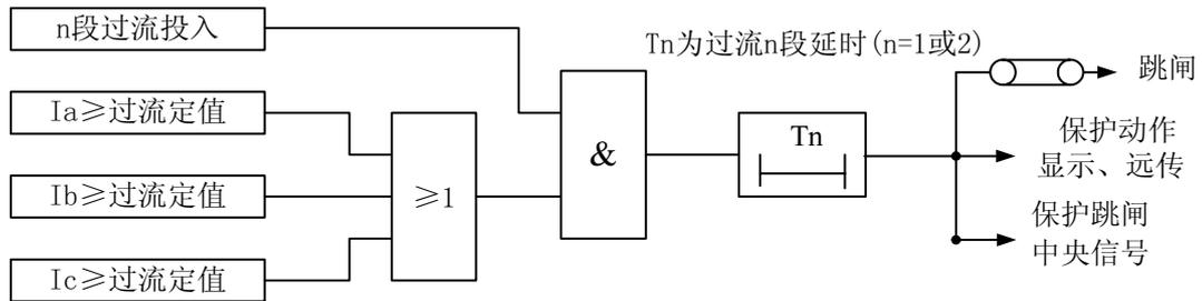
图 3-3-2 定时限过流保护原理框图
