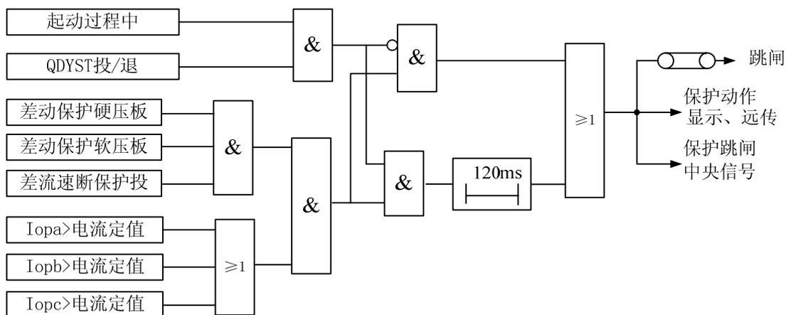
图 3-3-12 差流速断保护原理框图
