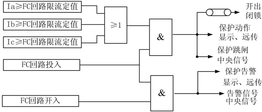
图 3-3-10 FC 回路保护原理框图
