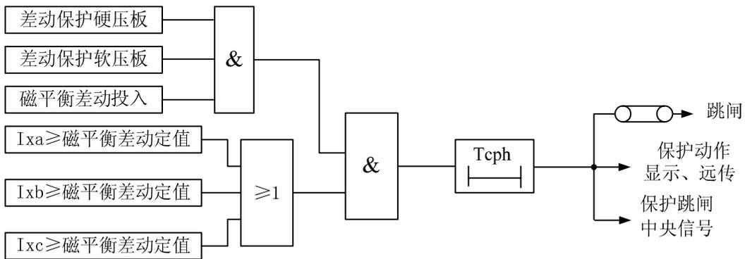
图 3-3-11 磁平衡差动保护原理框图
