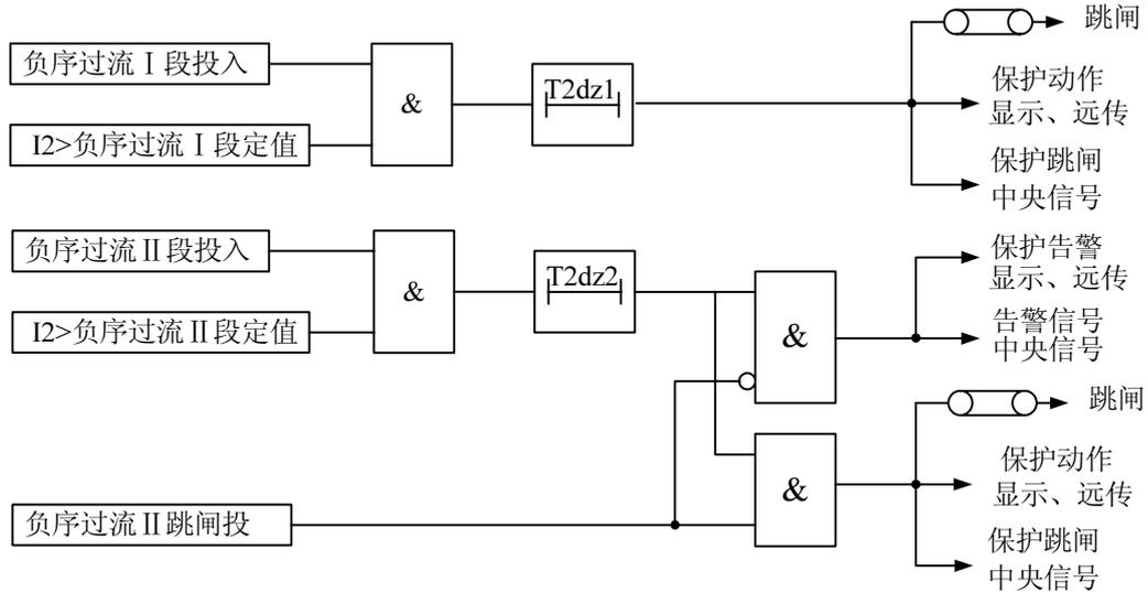
图 3-3-4 负序过流保护(定时限)原理框图
