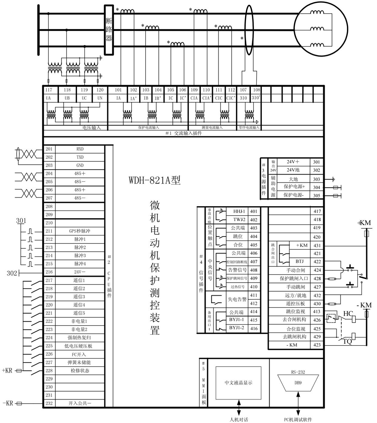
图 12-1: WDH-821A 装置接线示例图
