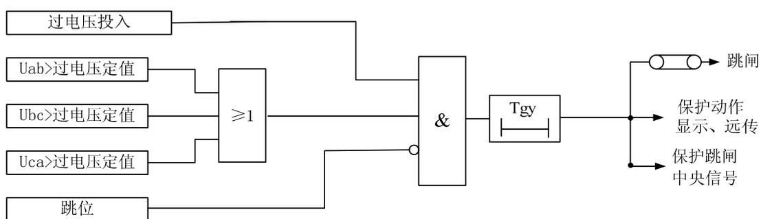
图 3-3-8 过电压保护原理框图
