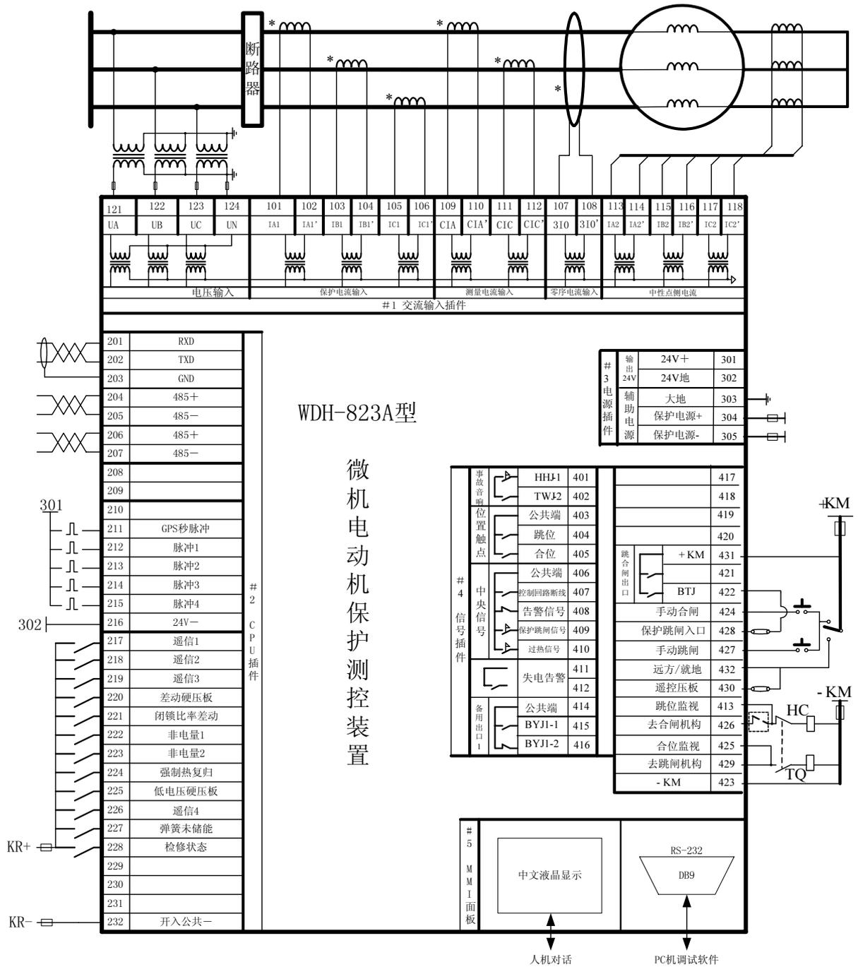
图 12-2: WDH-823A 装置接线示例图
