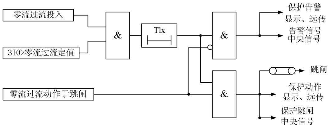
图 3-3-5 零序过流保护原理框图
