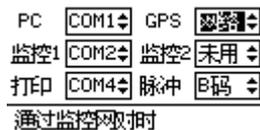
图 4-24 通信端口子菜单示例
