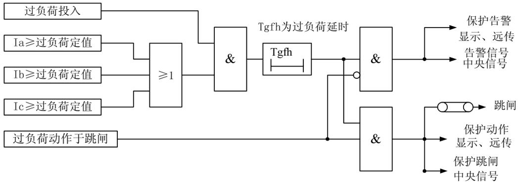
图 3-3-6 过负荷保护原理框图
