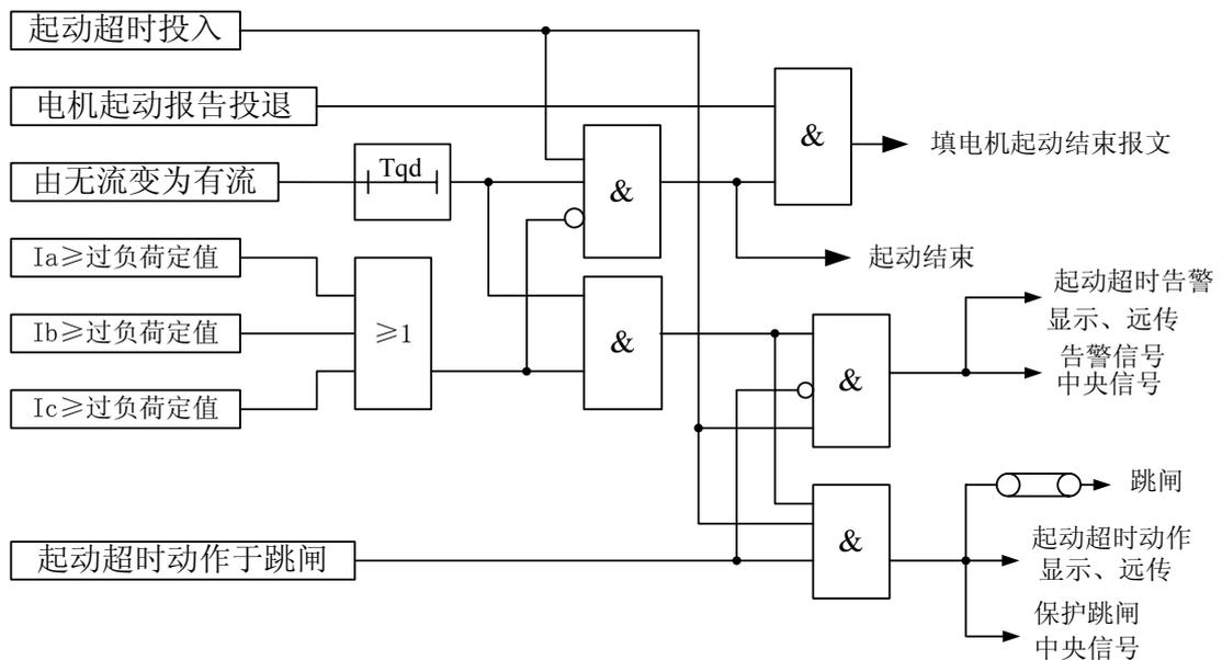
图 3-3-1 电动机起动超时保护原理框图
