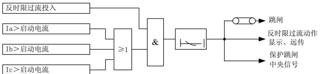
图 3-3-3 反时限过流保护原理框图
