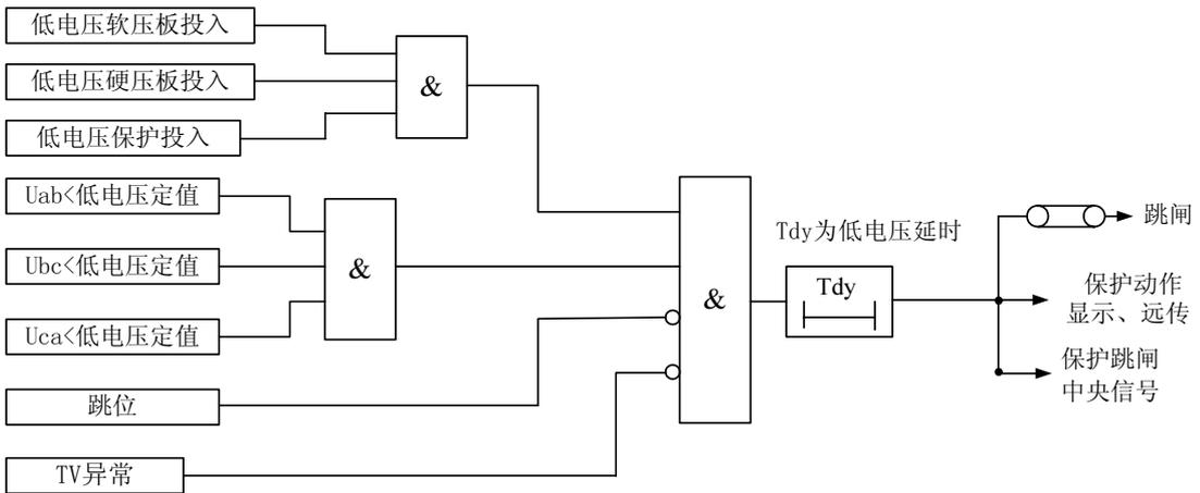
图 3-3-7 低电压保护原理框图
