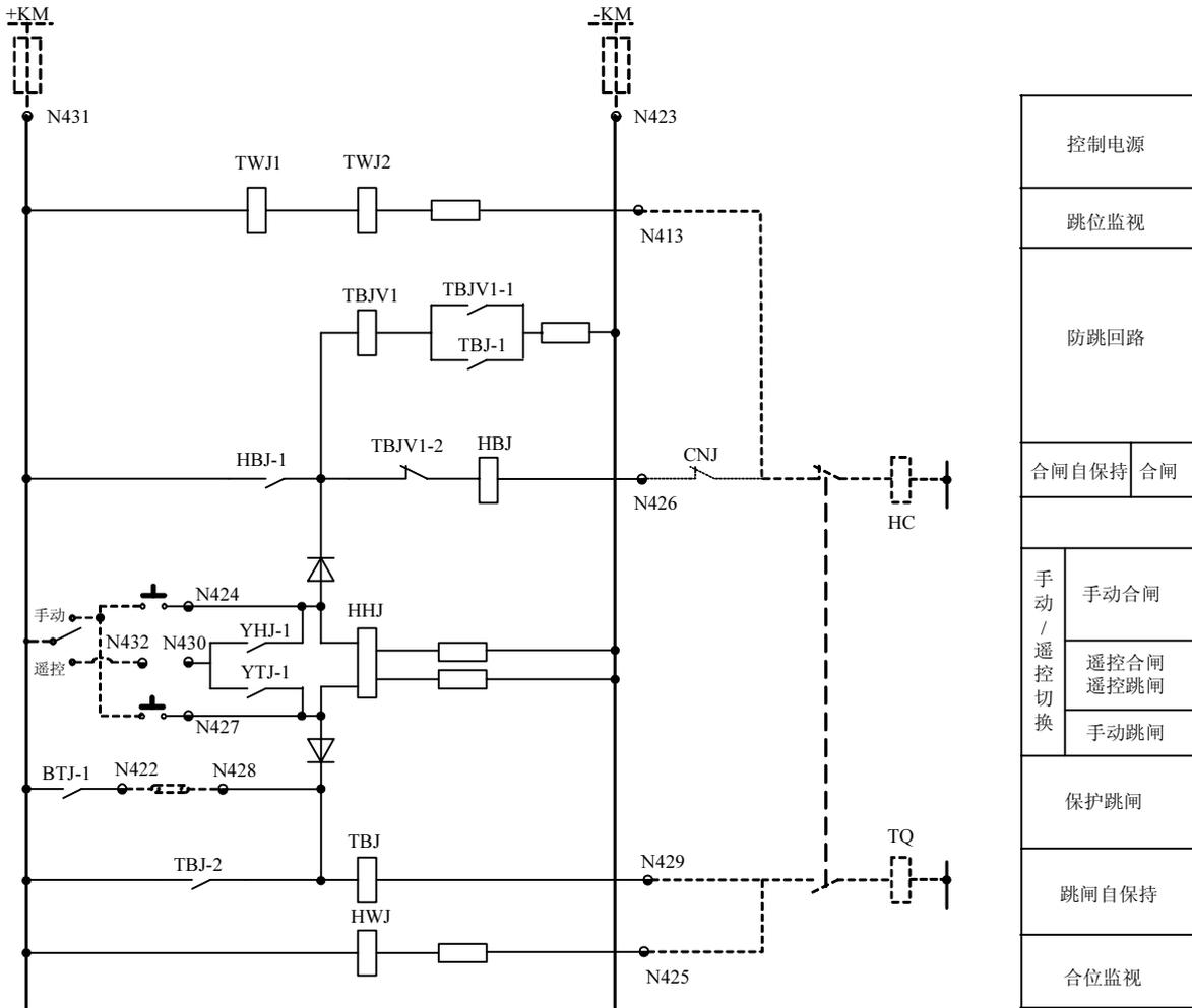
图 12-3: 装置操作回路原理图
