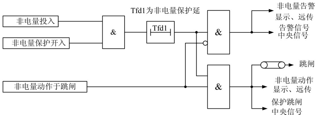
图 3-3-14 非电量保护原理框图
