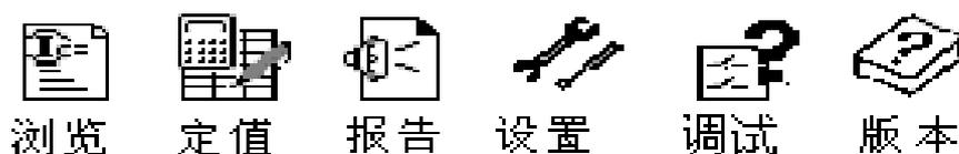
主菜单共有 6 个，分别为“浏览”、“整定”、“报告”、“设置”、“调试”、“版本”，以图标形式显示。每页画面显示 3 个图标，按左/右键循环显示。如进入主菜单后，当前页面显示“浏览”、“整定”、“报告”，按一次右键后，当前页面显示“整定”、“报告”、“设置”。
