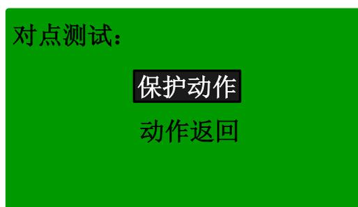
在对话框中，按“↑”和“↓”分别向上和向下移动光标选择保护动作和动作返回，选中后按确认键即可完成一次对点测试。
