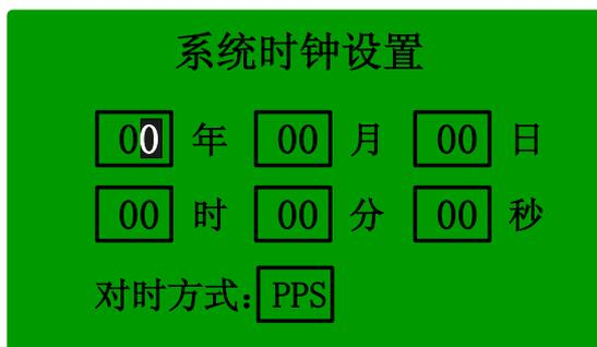
当光标位于校对方式选择框时，可以对装置的校对方式进行修改。按“+”、“-”键可以在“PPS”、“PPM”之间进行校对方式的选择。
