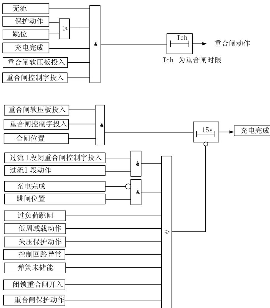
图 3-4 三相一次重合闸原理框图
