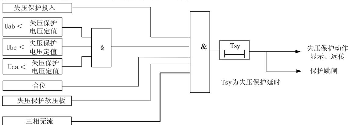
图 3-7 失压保护原理框图
