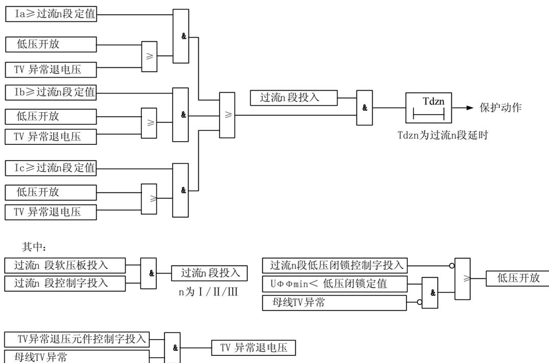
图 3-1 过流保护原理框图
