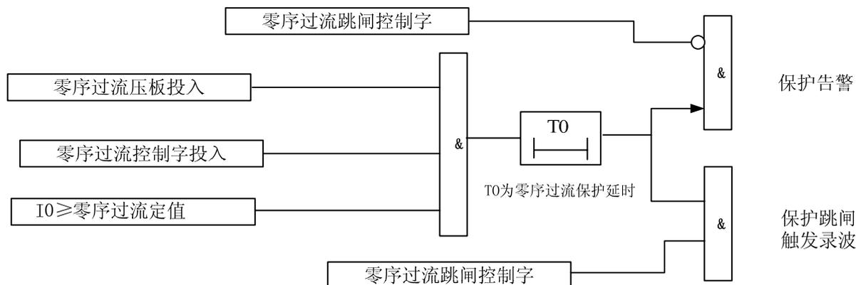
图 3-2 零序过流保护原理框图
