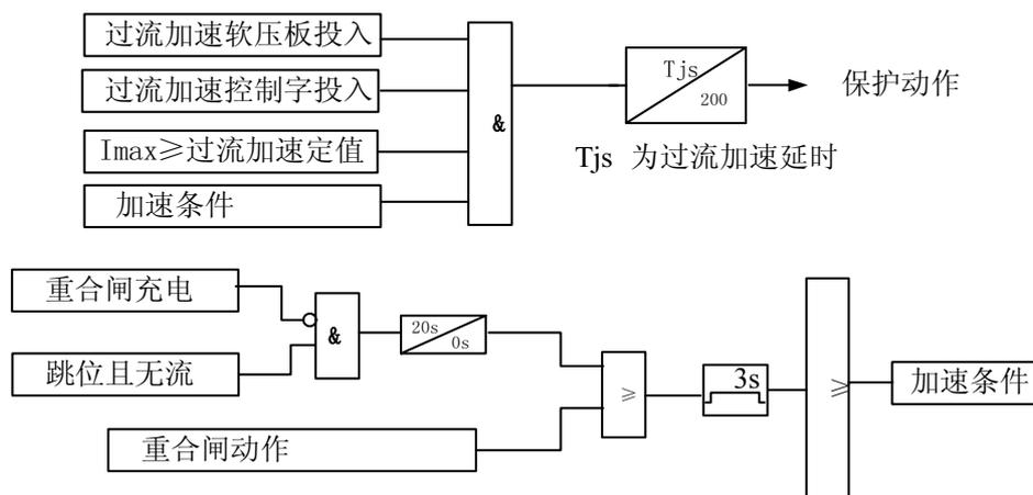
图 3-3 加速保护原理框图
