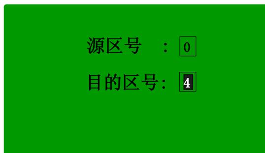
拷贝功能是指将源区号（0区）的定值整定值拷贝至目的区号（4区）。源区号和目的区号选择完成后按确认键提示用户输入密码。
