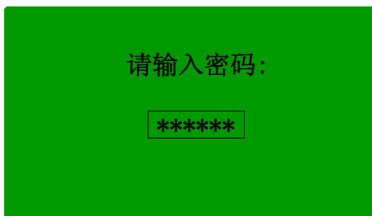
密码最大位数为 6 位，有四个方向键组成。输入完成后按“确认”键，如果密码错误，弹出对话框，提示用户密码不正确并返回到定值修改界面。如果密码正确，弹出对话框，提示用户定值存储成功。
