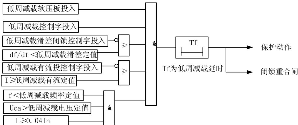
图 3-6 低周减载原理框图
