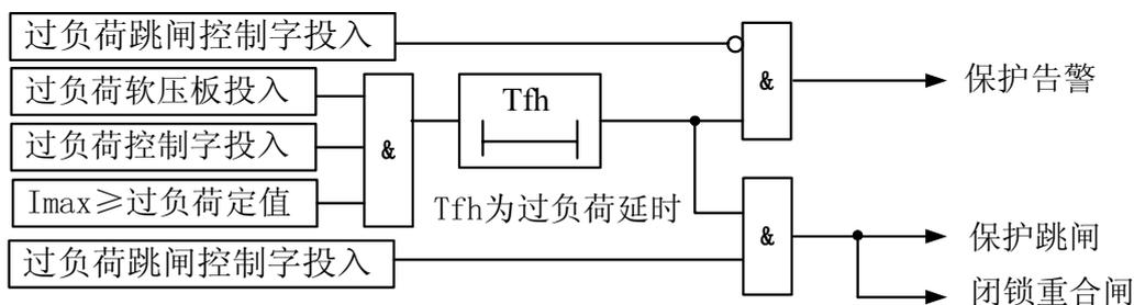
图 3-5 过负荷保护原理框图
